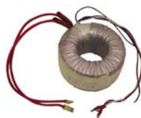
Transformateur 230V - 12V 230V - 12V Transformer
