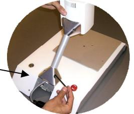
2 Une fois la partie supérieure de la machine bien fixée, brancher la prise.
