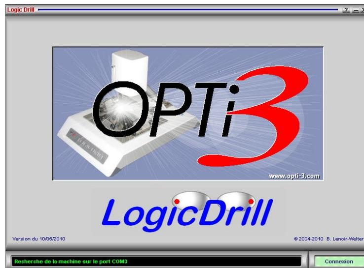
Avant tout, le logiciel commence par **rechercher la machine** sur les ports de communication disponibles. Si la machine n'est détectée sur aucun des ports, un message d'erreur vous signale le problème. Vérifiez alors que la machine est bien allumée et correctement branchée sur l'ordinateur, puis réessayez.
