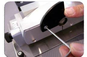
5 Utiliser la molette de réglage pour mettre à plat les deux plateaux, il est conseillé de s'aider d'une règle pour une bonne précision. On peut ensuite insérer l'aiguille à l'arrière et l'aligner sur le zéro.
