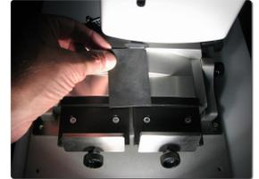
Si les pointes de la butée sont dans l'alignement de l'axe gravé sur les verres, le réglage est correct.
