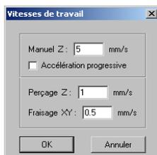
Pour modifier les **vitesses de travail** (déplacements manuels, perçage et de fraisage), cliquez sur la zone d'affichage de la vitesse. Les forets fins utilisés ont une résistance plus élevée au perçage (mouvement strictement vertical) qu'au fraisage (mouvement horizontal). Il est donc préférable de se limiter à des valeurs assez faibles – de l'ordre du mm/s – et indiquer une vitesse de fraisage moindre que la vitesse de perçage.
